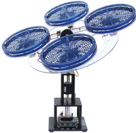
Fig. 5. Quadrotor hover system (Quanser.com).
